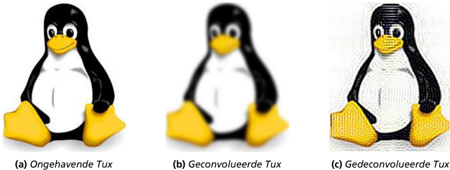
Figuur 4 De afbeelding in Figuur a wordt in Figuur b vervaagd. Figuur c is een poging om dit plaatje te herstellen. Rond de afbeelding vormen lijnen de contouren van het plaatje. Dit is een voorbeeld van een artefact in de afbeelding dat kan ontstaan door deconvolutie.
