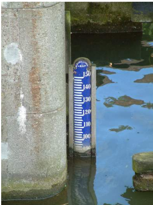
Figuur 2: Een peilschaal, waarmee het waterniveau kan worden afgelezen.
