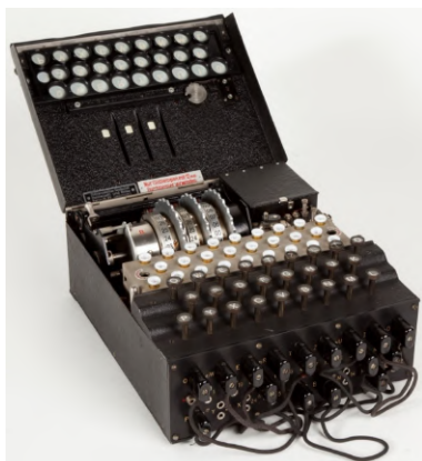
Figuur 2 Een Enigmamachine: bovenaan, vlakbij de deksel, zitten de drie tandwielen met elk 26 posities. Het onderste toetsenbord wordt gebruikt om te typen. Het bovenste 'toetsenbord' is een serie geletterde lampjes. Als je een toets indrukt, gaat er op het lampenbord een letter branden. De letter die oplicht is de letter waar de oorspronkelijke letter in verandert. Onderaan ziet men het bord met de 26 gaten, voor alle letters uit het alfabet, voor de extra 10! aan combinaties.
