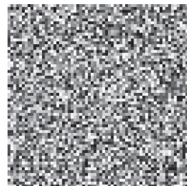
Figuur 7 Een voorbeeld van witte ruis, weergegeven als waarden van 0 (zwart) tot 1 (wit).
