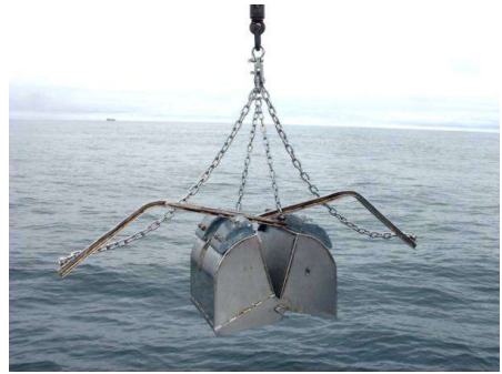
Figuur 3: Van Veen grab, klaar om een monster te nemen. Wanneer hij de grond raakt, gaat hij vanzelf dicht.
