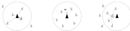
Figuur 1 De richting die vogel opgaat bij respectievelijk Separation, Alignment en Cohesion.
